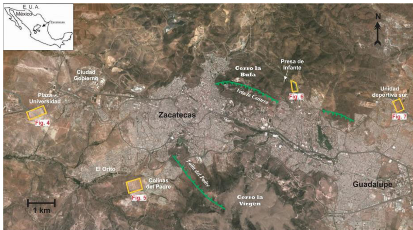
Figura 1. Imagen de Google Earth con la ubicación del área de estudio así como de los perfiles de georadar y de los elementos geográficos y estructurales mencionados en el texto. Las líneas azul discontinuas son los segmentos de los arroyos que están en las zonas donde se obtuvieron los perfiles de georadar.
