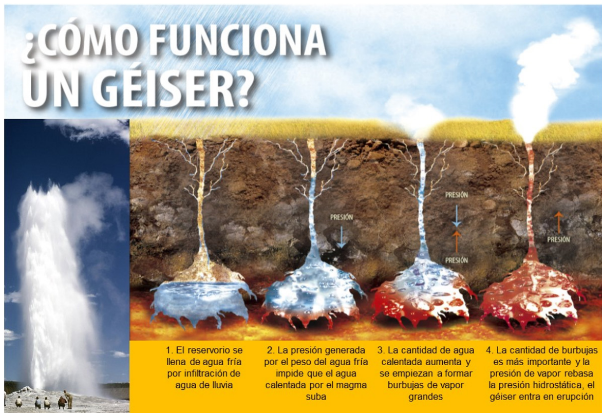
Figura 4. Infografía ilustrando el funcionamiento de un géiser en 4 etapas. Infografía modificada de https://expertosendetalles.files.wordpress.com/2013/07/infografia.jpg . La fotografía corresponde al géiser “Old Faithful” del parque nacional “Yellowstone” (EE.UU.), foto tomada de la galería de fotos del parque nacional.
