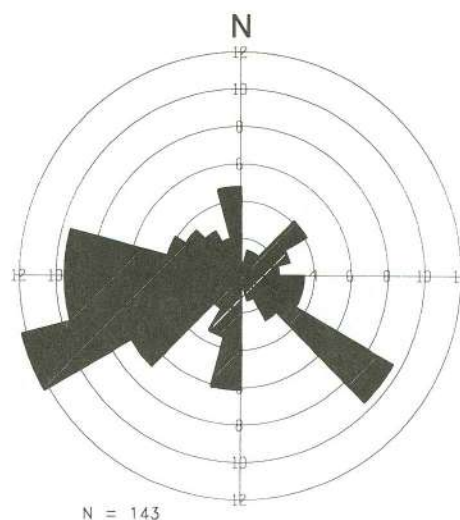
Figura 9. Diques aplítico-pegmatíticos. Su distribución puede asignarse a por lo menos dos de los sistemas primarios en las rocas intrusivas, que controlan la circulación y el emplazamiento de las soluciones residuales: sistema cruzado de 225^{\circ} a 285^{\circ} y el diagonal de 120^{\circ} a 135^{\circ} .
