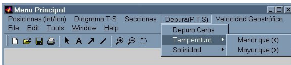
Fig. 3l. Aquí se muestran las dos opciones que podemos tener en la depuración de ciertos valores de temperatura, aparte de valores iguales a cero. Estas mismas opciones existen para la salinidad.
