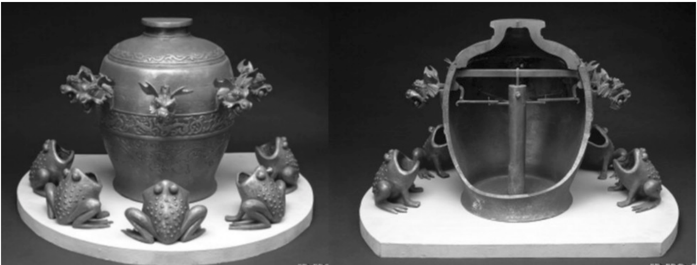
Figura 2. Primer "sismógrafo" inventado por el filósofo chino Chang Heng aproximadamente en el año 132 D.C. Este sismoscopia no tiene ningún control del tiempo de registro. Al ocurrir un sismo las pelotas sostenidas por dragones caían en la dirección del movimiento (fotografía de Science Museum/Science & Society Picture Library; http://www.nmsi.ac.uk ).
