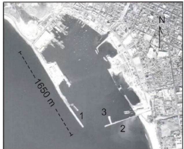
Figura 2. Imagen del puerto de Ensenada, Baja California, que ilustra la cronología de tres de sus escolleras: La principal data del año 1955 y se indica con el numero 1; la segunda escollera en el extremo Sur del puerto data del año 1980 y se indica con el numero 2 y, una tercera escollera o espolón, data del año 1993 y se indica con el numero 3. Imagen INEGI, noviembre, 1993.
