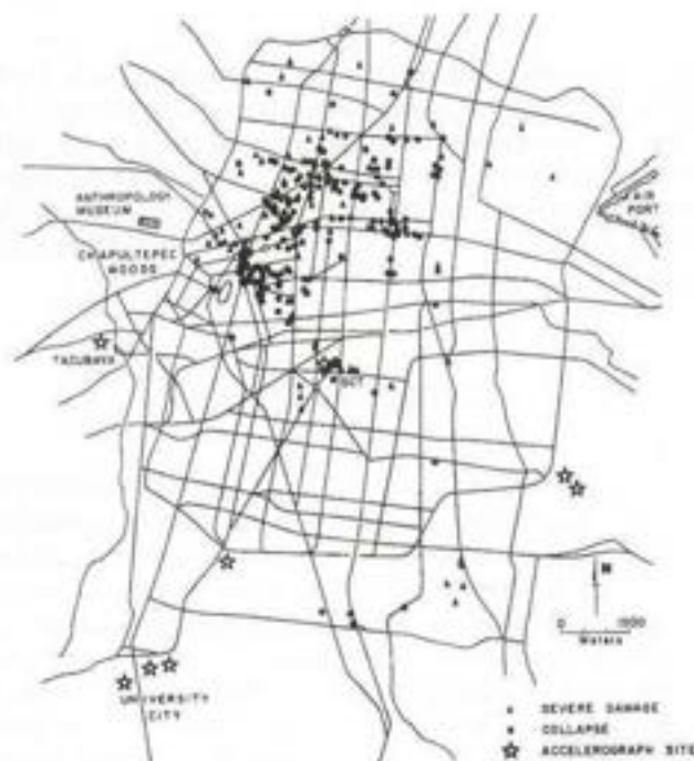
Figura 1. Distribución de daño estructural severo y sitios donde se obtuvieron los datos de los movimientos fuertes del suelo. Solamente las calles principales de la ciudad de México están representadas en la figura.
