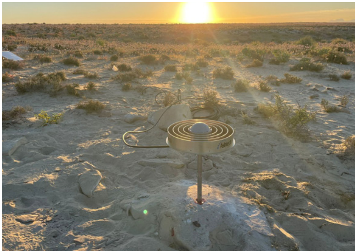
Figura 2. Antena geodésica choke-ring sujeta por medio de una extensión al adaptador en acero inoxidable para piezas con rosca de 5/8"-11. (Manufactura: Laboratorio de Metalmecánica – CICESE) en el vértice LOLO.
