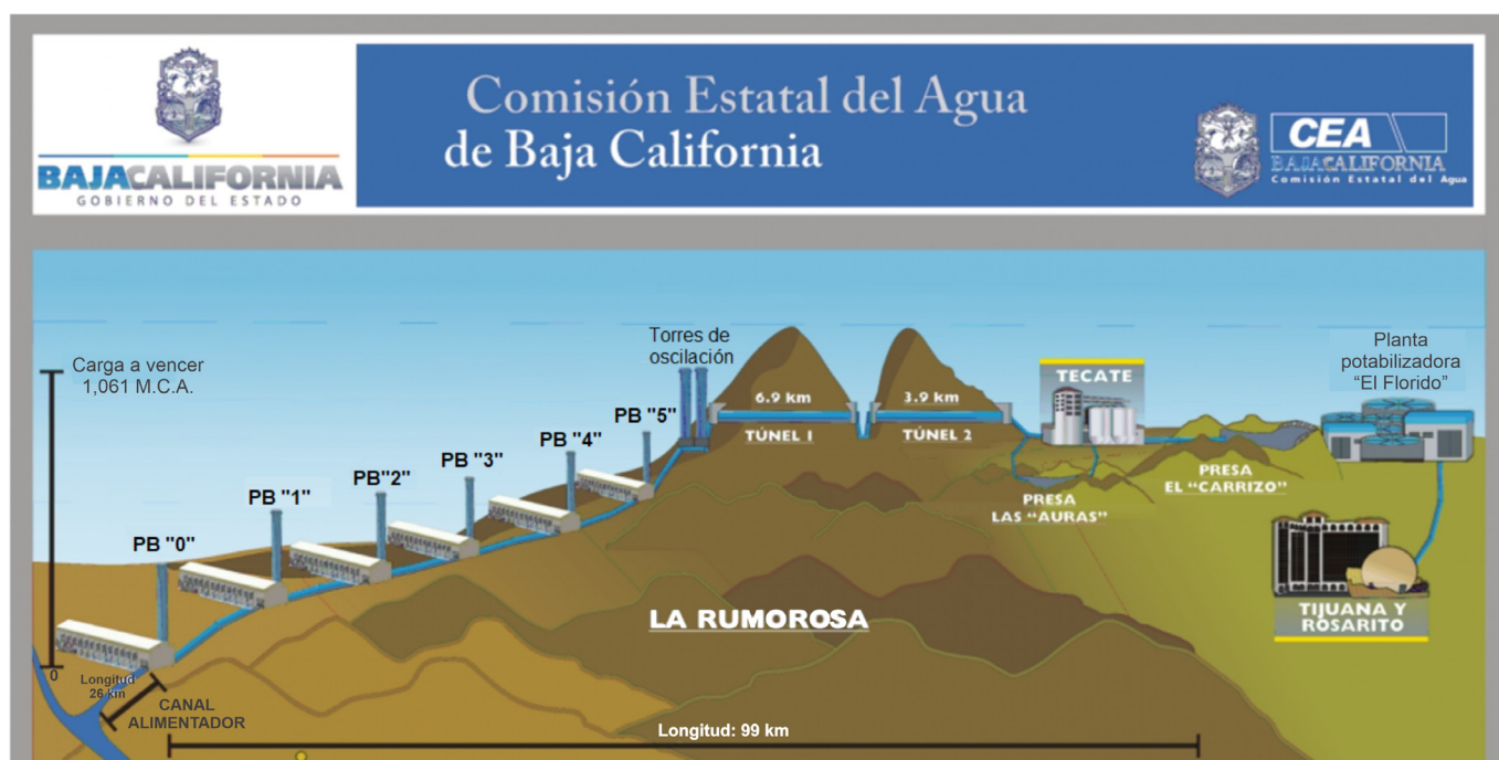
Figura 2. Perfil del acueducto Colorado-Tijuana. La altura a vencer es \approx 1,000 metros y la distancia a cubrir \approx 100 kilómetros.
