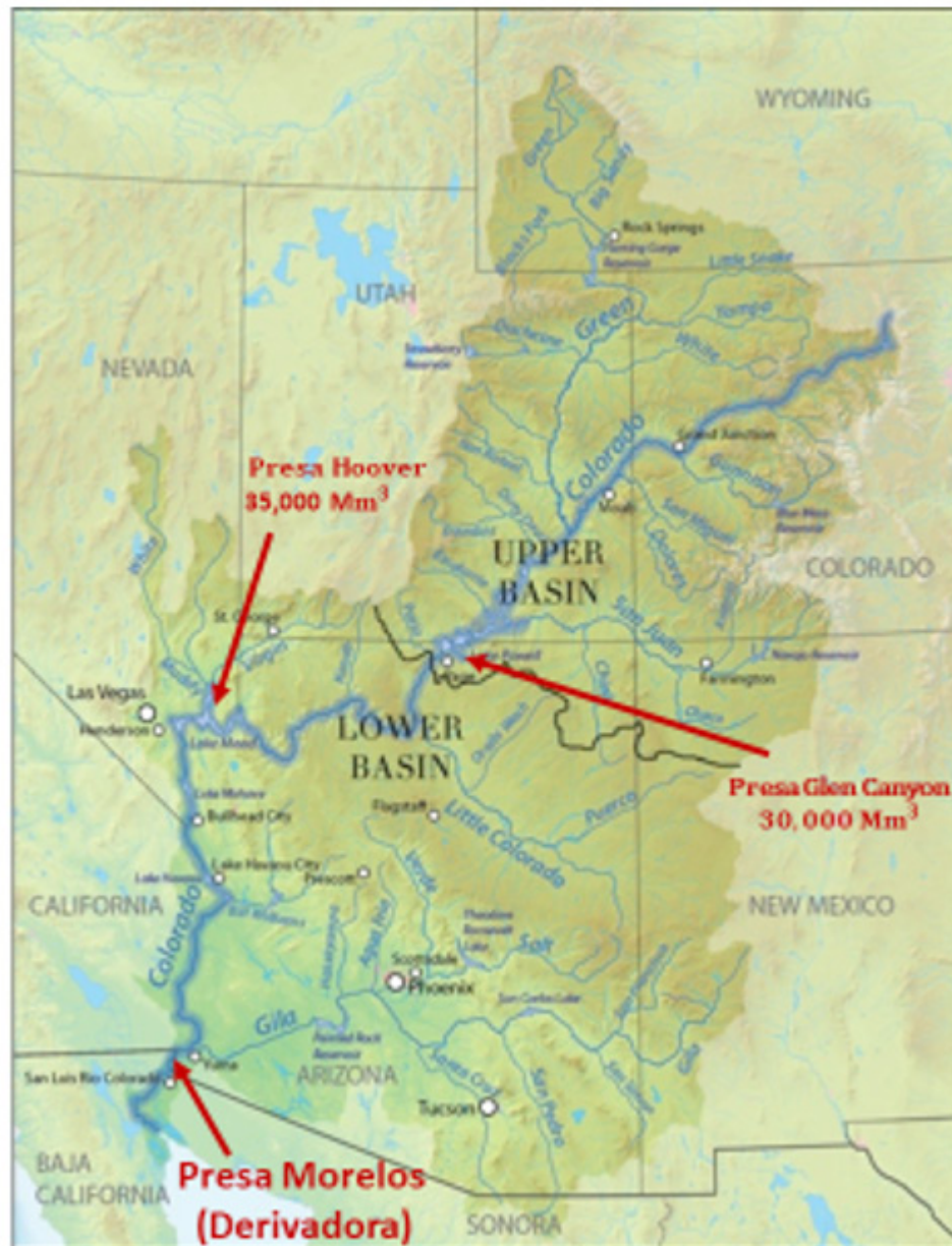
Figura 17. Río Colorado y sus afluentes. La entrega de agua a México se hace de forma programada a lo largo del año mediante diferentes presas como la Hoover y Glen Canyon. https://www.wikiwand.com/es/articles/Lago_Granby#/media/Lago_Granby|Archivo:Coloradorivermapnew.jpg
