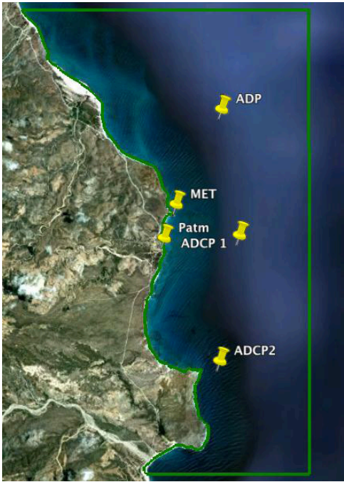
Figura 2. Posición de los instrumentos sobre una foto obtenida de Google Earth. La línea verde delimita el Parque Nacional. Se señala la posición de los tres perfiladores de corrientes: al Norte (ADP), al centro un perfilador (ADCP 1) con un sensor de presión y al sur el tercer perfilador (ADCP 2). La estación meteorológica se instaló en el Cabo Pulmo (MET) y un sensor de presión atmosférica en una casa de la localidad (Patm).
