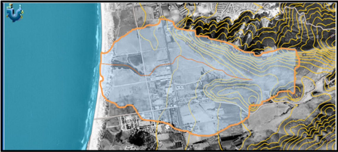
Figura 10. Área de captación de escorrentía superficial con el cauce principal que alimenta la cuenca de aproximadamente 4 km2 de La Lagunita. Tomado y modificado del INEGI, 2013.
