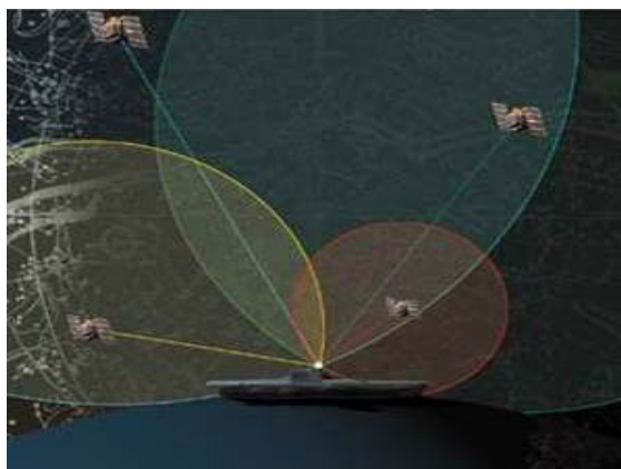
Figura 3. Tiempos de recorrido calculados en un receptor GPS que recibe señales desde tres satélites cada vez más lejanos. Los tiempos se convierten a distancias mediante la ecuación indicada y el receptor calcula su posición. En este caso no se trazan círculos sino esferas.
