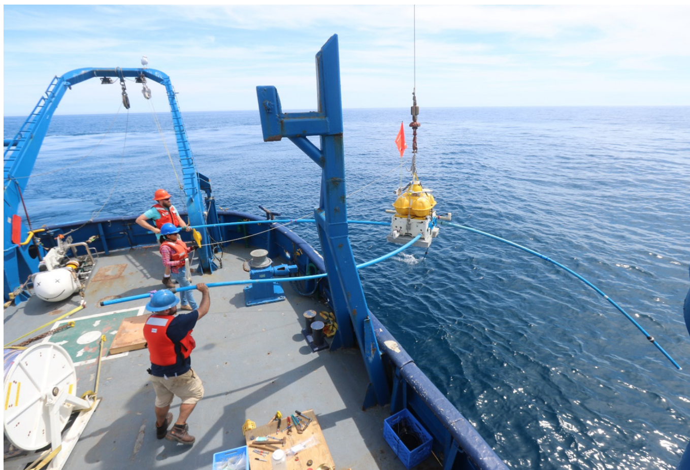
Figura 7. Despliegue de un instrumento de medición EM (Cortesía de Steven Constable).
