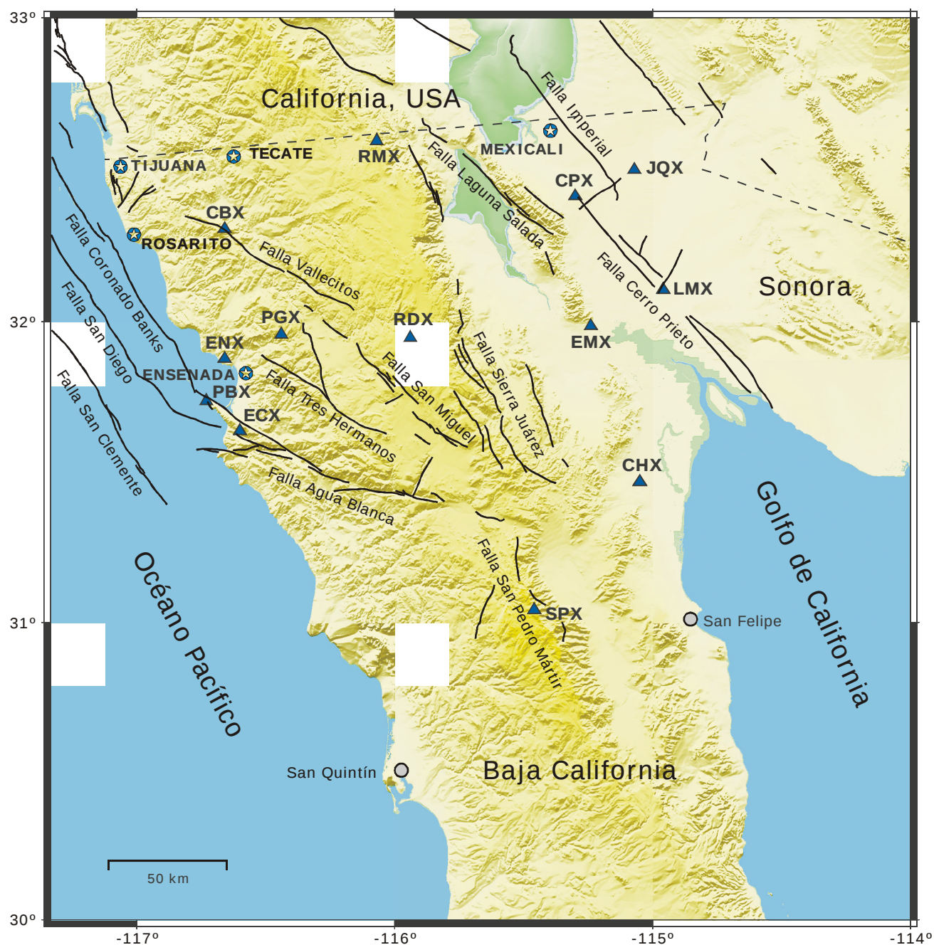
Figura 1. Principales fallas geológicas de la región norte de Baja California y estaciones sismológicas (triángulos azules) de la Red Sísmica del Noroeste de México (RESNOM).
