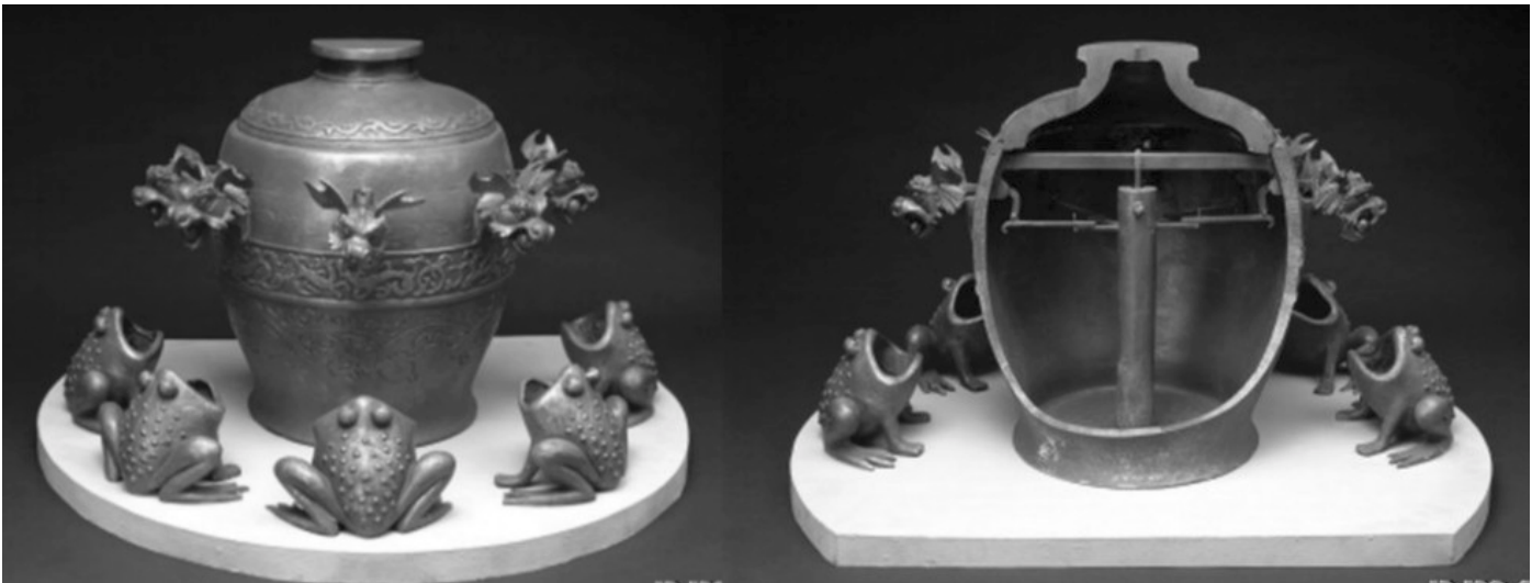
Figura 2. Primer "sismógrafo" inventado por el filósofo chino Chang Heng aproximadamente en el año 132 D.C. Este sismoscopio no tiene ningún control del tiempo de registro. Al ocurrir un sismo las pelotas sostenidas por dragones caían en la dirección del movimiento (fotografía de Science Museum/Science & Society Picture Library; http://www.nmsi.ac.uk ).
