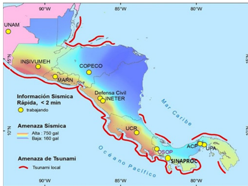
Figura 3. Distribución de instalaciones de SeisComP en Centroamérica. Los puntos en amarillo corresponden a los sitios donde ha sido implementado SeisComP. La instalación del sistema ha sido realizada por la compañía OSOP en casi todos los países de América Central y México (UNAM), con excepción de Nicaragua donde fue el INETER quien lo instaló (esta imagen es cortesía del Dr. Wilfried Strauch).
